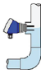
Detección de presencia de líquido en tuberías
